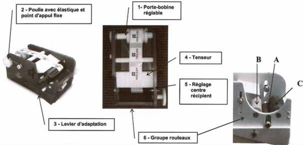
**1- PORTE-BOBINE RÉGLABLE:** étudié pour l'insertion facile de la bobine d'étiquettes. Et doué de deux cônes montés sur un pivot que je donne la possibilité d'une régulation rapide dell' je roule sur l' étiquetage
