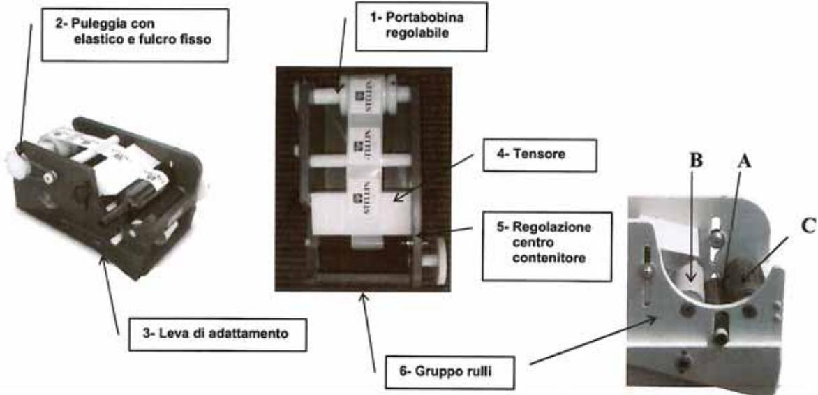
**1- PORTABOBINA REGOLABILE:** ideato per il facile inserimento della bobina di etichette. E' dotato di due coni montati su un perno che danno la possibilità di una rapida regolazione dell' rotolo sull' etichettatrice.
