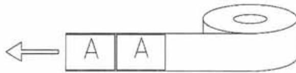
La distance recommandée entre deux étiquettes qui se suivent ou entre deux étiquettes/contre-étiquettes est de 10 mm.
