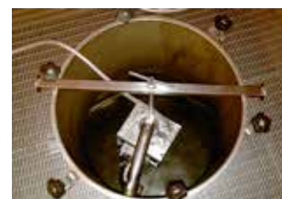
LE RACCORD VISSÉ DANS LA TRAPPE A LA COLONNE DE REMONTAGE
