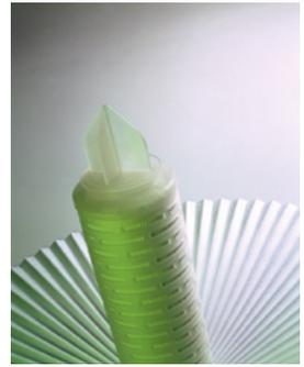
La cartouche POLYSAN est composée d'un ensemble de 5 couches de polypropylène plissées avec une porosité graduellement dégressive permettant une parfaite utilisation de la surface de filtration, une très grande capacité de rétention ainsi qu'un seuil de filtration précis et fiable.
