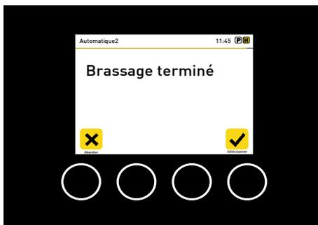
Lorsque le temps d'ébullition s'est écoulé, un signal sonore indiquant la fin du processus de brassage retentit à nouveau. Validez avec *Sélectionner*. Le chauffage s'éteint.
