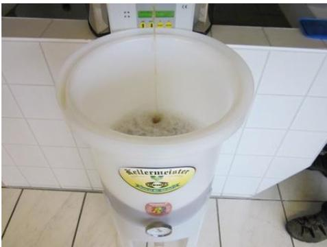
Versez le moût dans un fût de fermentation de 12 / 30 / 60 l stérile. Au préalable, désinfectez le fût et les ustensiles de mise en bouteilles avec un désinfectant. Ne versez pas les dépôts situés dans le fond de la cuve. Ajoutez 11 g de levure sèche dans le moût et fermez le fût de fermentation avec une bonde remplie en haut d'acide sulfureux.
