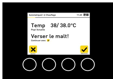
Lorsque la température de trempage est atteinte, un signal sonore retentit et les indicateurs lumineux clignotent, il faut valider avec *Sélectionner*. Ainsi, la pompe s'éteint. Suivez maintenant les instructions de la commande de brassage.
