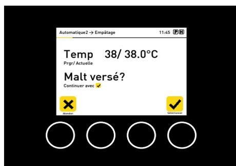
Après avoir versé le malt, validez avec *Sélectionner*. Le système pose la question de sécurité suivante : « Malt versé ? ». Appuyez sur *Sélectionner* pour démarrer le processus de brassage à proprement parler avec le Braumeister. La pompe et le chauffage démarrent. Le moût monte dans le tuyau et déborde. Le circuit est établi et le malt est lavé par le pompage au cours des phases suivantes.
