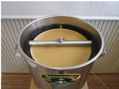
Continuez maintenant en mode automatique avec *Sélectionner*. L'eau de brassage légèrement colorée monte et déborde. Le circuit a commencé. Les phases de brassage suivantes sont exécutées entièrement automatiquement conformément au programme. Pendant certaines phases de brassage, la commande déclenche une courte pause pour repositionner le malt. L'écran affiche les températures réelle et théorique ainsi que le temps restant à s'écouler réel et théorique pour chaque phase.
