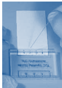
Abb. 1: Auftragen der Proben auf eine DC-Fertigfolie mit Kapillare und Auftragschablone
