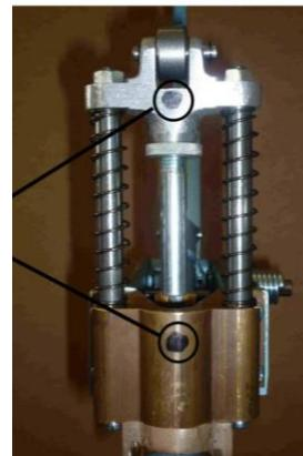
Les marques se trouvant sur le bloc de compression et sur le porte-colonnes doivent se trouver du même côté.
